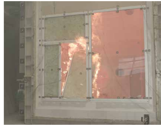
EgoKiefer Brandschutzfenster nach EI30 geprüft, garantieren eine Feuersicherheit von mind. 30 Minuten.
